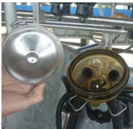
Inspecção de componentes do sistema de ordenha mecânica para avaliação de acúmulo de resíduos
