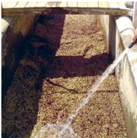
Tanque de degomagem
