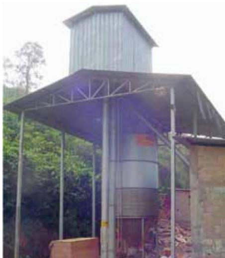
*Secador mecânico vertical*
