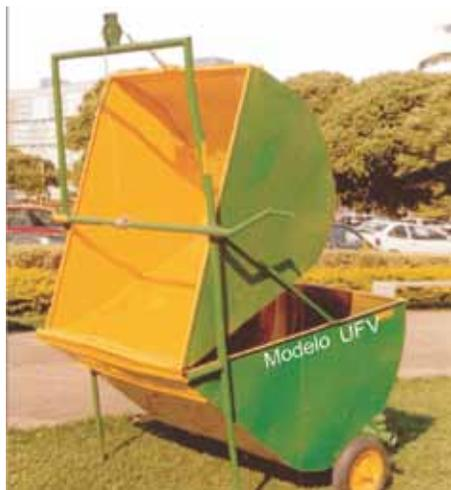
Lavador mecânico de acionamento manual – Modelo UFV
