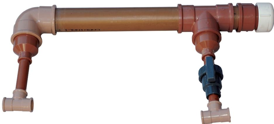
6- Na extremidade do T de 60 mm, cole 5 cm de tubo PVC de 60 mm, depois o adaptador PVC de 60x2 soldável. Teste os encaixes antes de colar. No adaptador, rosquear a capa PVC de 60 mm. Nesta extremidade será colocado o cano contendo as pastilhas de cloro.
