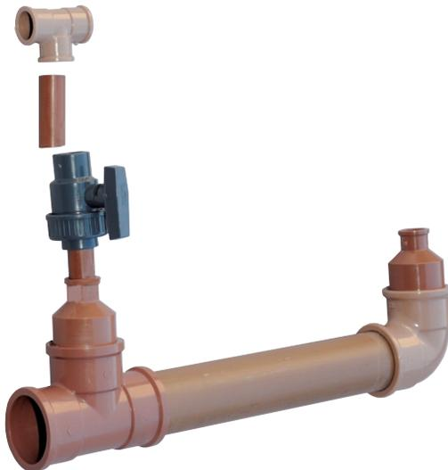
5- Na extremidade do encaixe do joelho, onde foi colada a bucha redutora de PVC 60x25 soldável, cole 10 cm de tubo PVC de 25 mm de espessura e depois o T PVC de 25 mm soldável. Teste os encaixes antes de colar.
