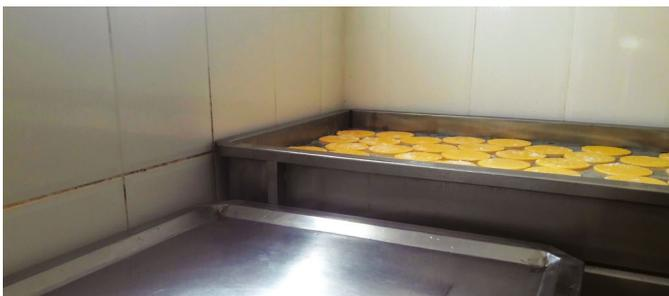
Prensa em aço inox para moldagem e dessoragem da massa, antes do processo de salga em salmoura.
