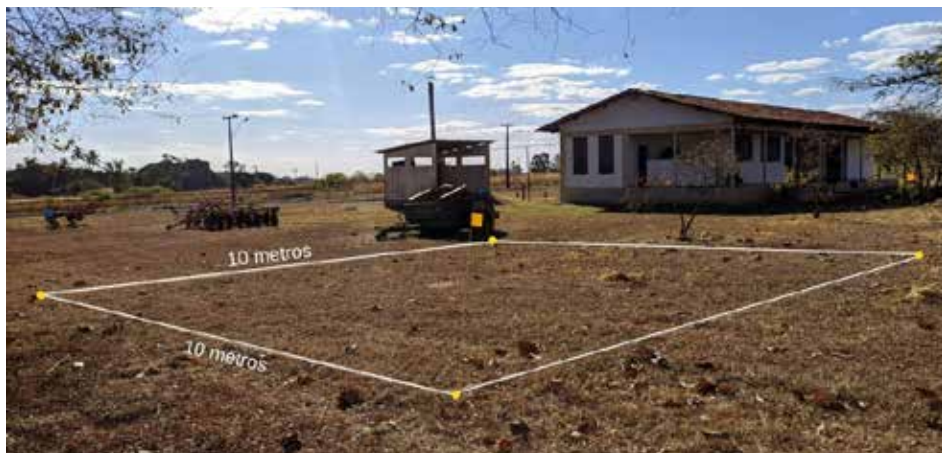
Figura 10. Demarcação de área 10m x 10 m para calibração.
