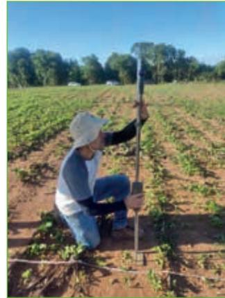
**Foto 3.** Penetrômetros utilizados na determinação da resistência do solo a penetração.
