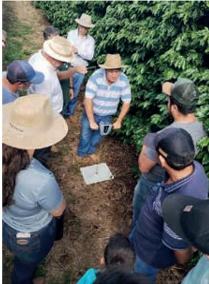
**Foto 8** - Avaliação de compactação com penetrômetro digital
