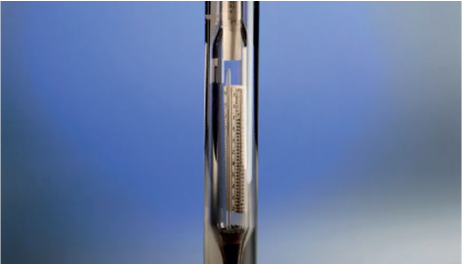
Figura 7 – Aerômetro de Baumé
